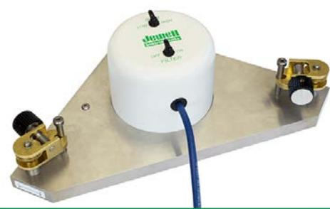
Nel 1987, abbiamo consegnato un grande sistema di misurazione dell'inclinazione alla centrale nucleare di Àsco 2 per il monitoraggio della stabilità delle fondamenta. Come parte del processo di accettazione, quattro inclinometri a montaggio superficiale, tra cui i modelli 711, sono stati sottoposti a test di invecchiamento accelerato in un impianto di sterilizzazione tramite radiazioni nella California meridionale.
